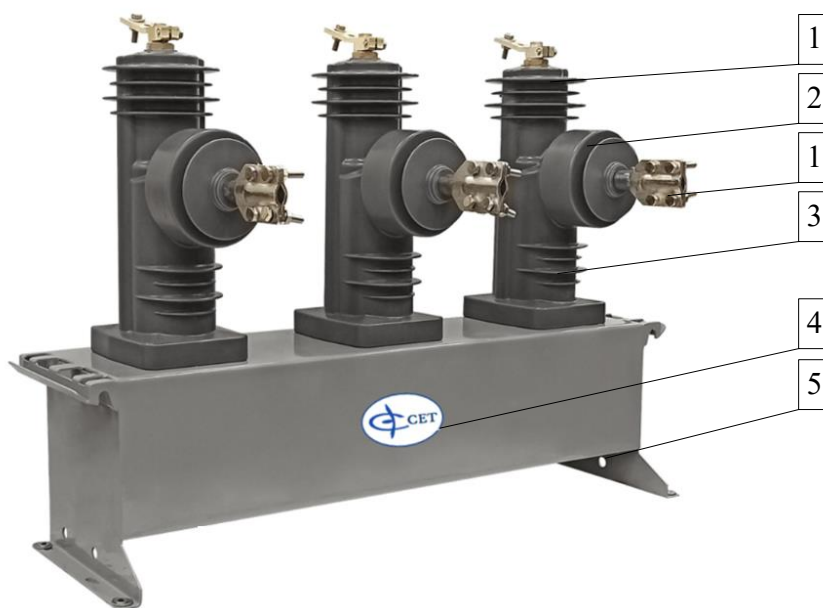
Рисунок 2 – Общий вид коммутационного модуля реклоузера (вид спереди) 1 – силовые контакты 2 – встроенная катушка Роговского; 3 – фазная колонка; 4 – логотип производителя; 5 – корпус коммутационного модуля;
